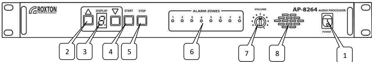
1. Кнопка включения/выключения питания блока.
