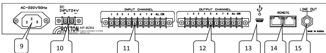
9. Разъем для подключения внешнего источника питания: AC-220В 50Гц.
