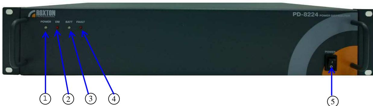
1. **Кнопка POWER** - При нажатии этой кнопки светодиод загорается зеленым цветом. Переменное напряжение 220В 50Гц поступает на выходную розетку AC2 (поз.2 задней панели), постоянное напряжение на выходные клеммы 3,4 (поз.11 задней панели).
