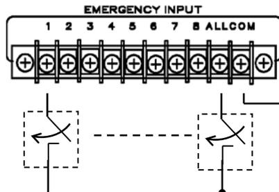
При замыкании клеммы 1-8, и клеммы COM включаются соответствующие группы усилителей RA-8236 (см. инструкцию к RA-8236), индикаторы CH1-CH8 (поз.4) загораются красным цветом. Сигнал со входа EM1 поступает на выход блока OUT (поз.16) и на выход усилителя RA-8236 который запрограммирован в соответствующую группу. При этом основной регулятор громкости VOLUME (поз.8) блокируется, регулировка громкости становится возможной только при помощи регулятора EM1 (поз.17).
