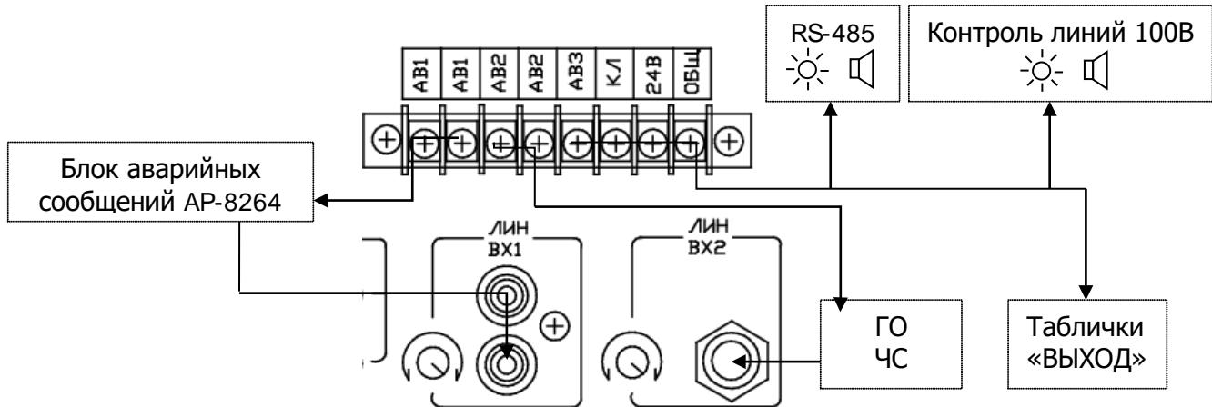
При такой схеме включения, при поступлении на клеммы 1-8 АВАРИЙНЫЕ ВХОДЫ (поз. 20) аварийного сигнала от системы ОПС, подключаются соответствующие зоны, активируется модуль речевых сообщений, и в выбранные зоны через звуковой вход ЛИН. ВХ. 1, поступает записанное сообщение.
