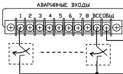
При замыкании клеммы 1-8, и клеммы ОБЩ включаются соответствующие зоны, индикаторы зон 1-8 (поз.4) загораются красным цветом. Сигнал со входа ЛИН. ВХ. 1 поступает на усилитель мощности, при этом основной регулятор громкости ГРОМКОСТЬ (поз.7) блокируется, регулировка громкости становится возможной только при помощи регулятора ЛИН. ВХ. 1 (поз.16)).
