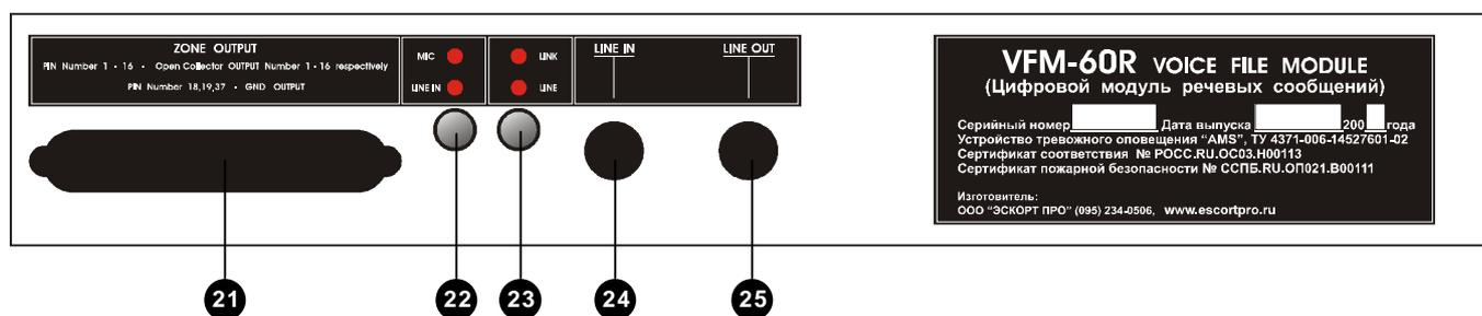
**21. РАЗЪЕМ OUTPUT CHANNEL** – С этого разъема снимается сигнал управления релейным блоком (RG-9116). Соответствие контактов разъема коммутируемым зонам.
