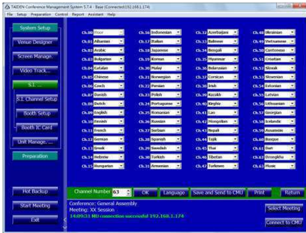
Настройка канала синхрперевода
