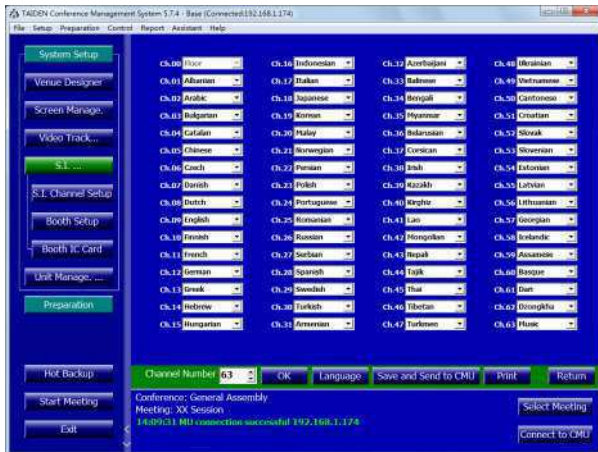
Настройка канала синхрперевода
