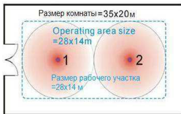
Рис. 3.12 Два трансивера покрывают всю рабочую зону
