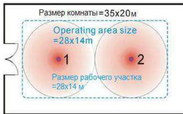
Рис. 3.11 Два трансивера не способны покрыть всю рабочую зону
