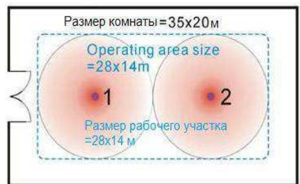
Рис. 3.12 Два трансивера покрывают всю рабочую зону
