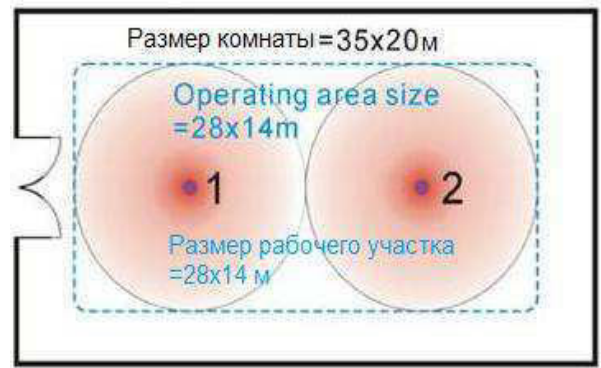
Рис. 3.11 Два трансивера не способны покрыть всю рабочую зону
