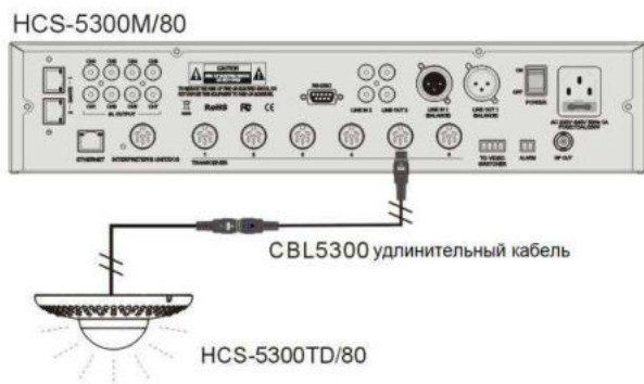
Рис. 3.35. Подключение цифрового ИК ресивера к ЦБ цифровой инфракрасной беспроводной конференц-системы
