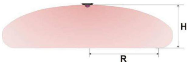
**Зона покрытия цифрового ИК передатчика****HCS-5300TD/80**
