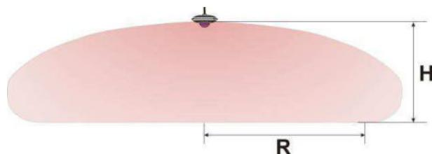
**Зона покрытия цифрового ИК передатчика HCS-5300TDS/80**
