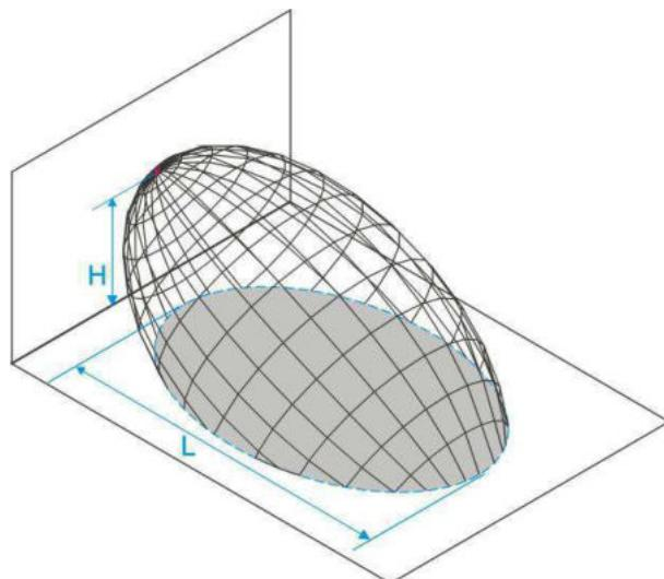
**Зона покрытия цифрового ИК передатчика HCS-5300TDS/80**
