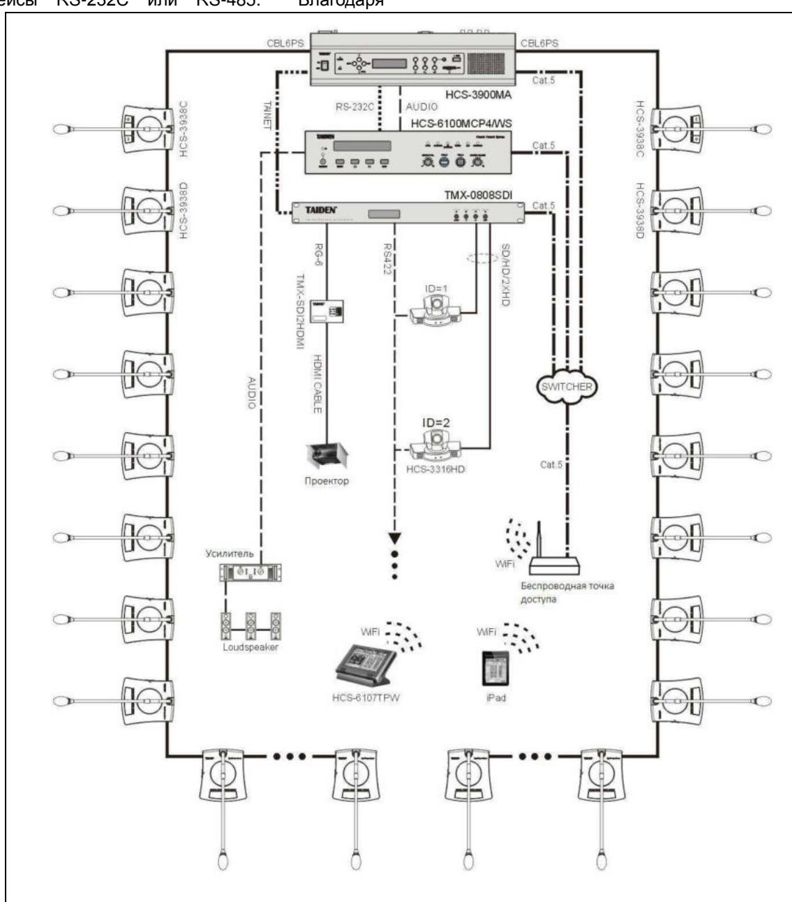
Рис 4.3 Соединение между ЦБ и центральной системой управления
