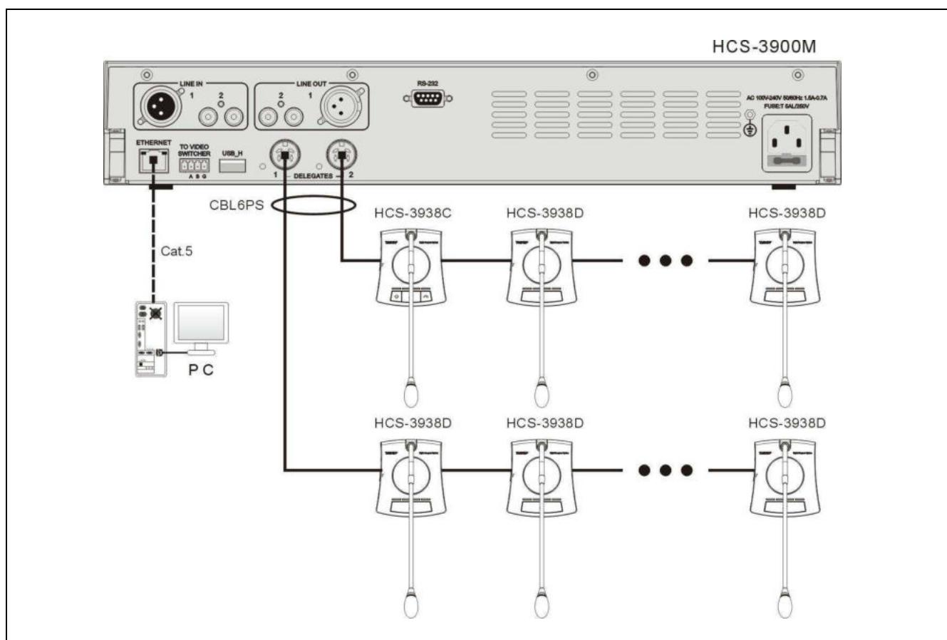
Рис. 4.1. Соединение между ЦБ и конференционными пультами
