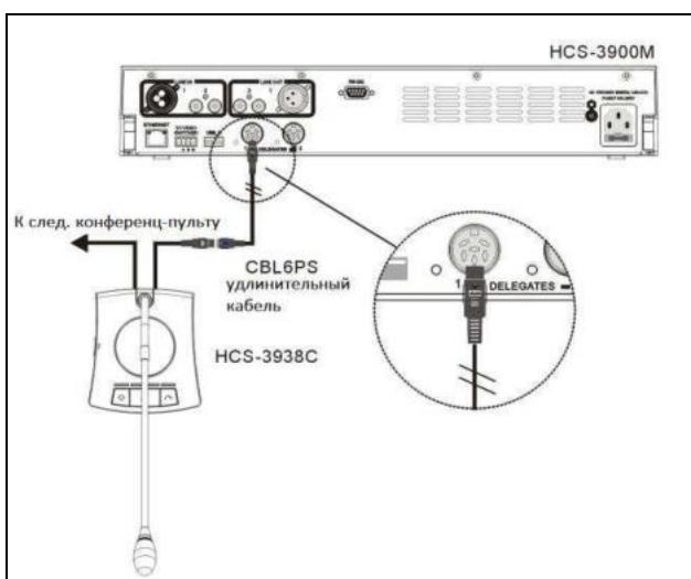
Рис. 3.2. Подключение пульта серии HCS-3938 к ЦБ
