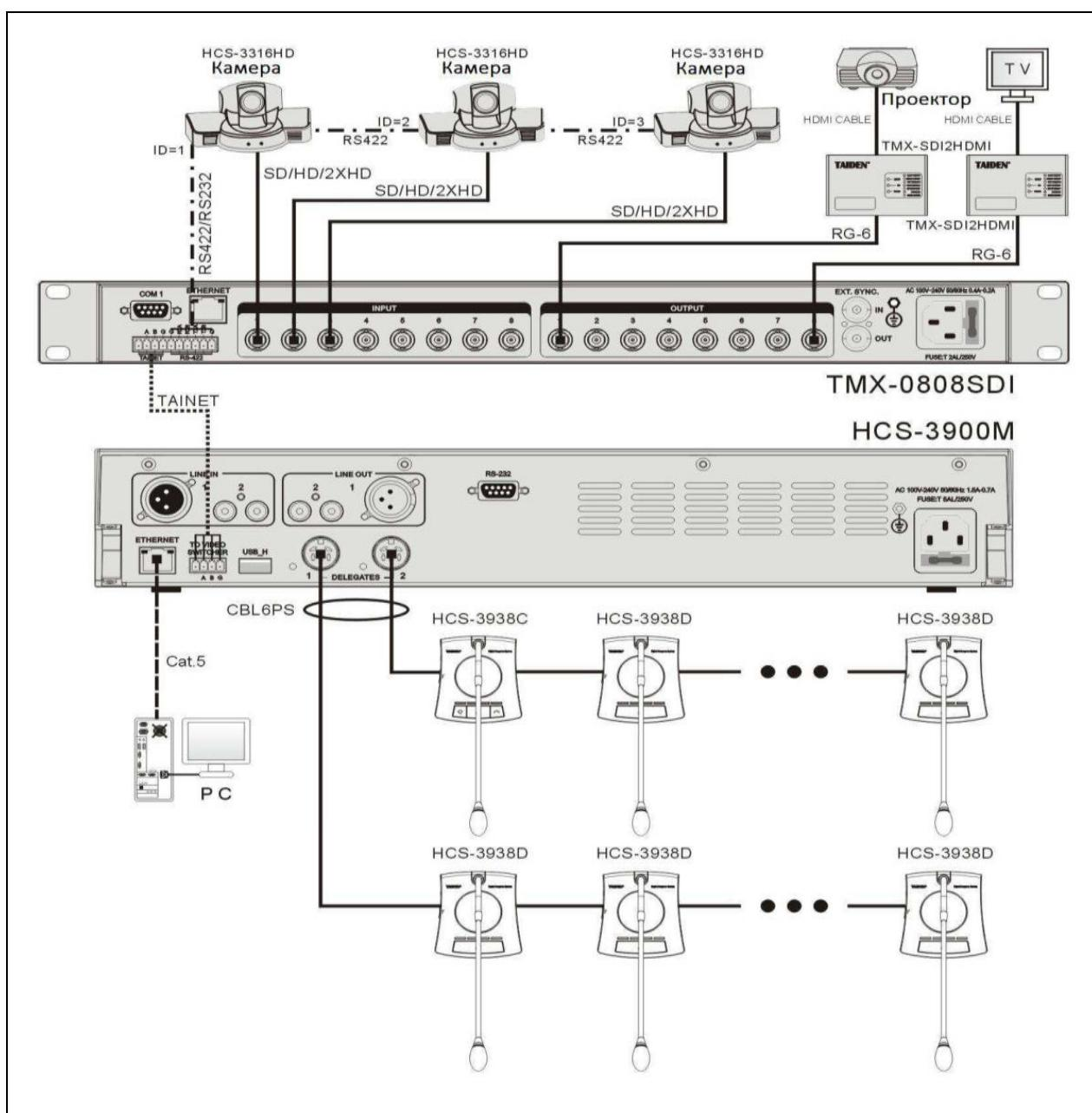
Рис. 4.2 Соединение между ЦБ и системой автоматического видеомониторинга
