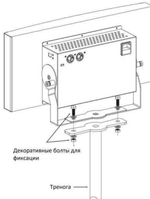
Рис. 3.9 Установка на штатив
