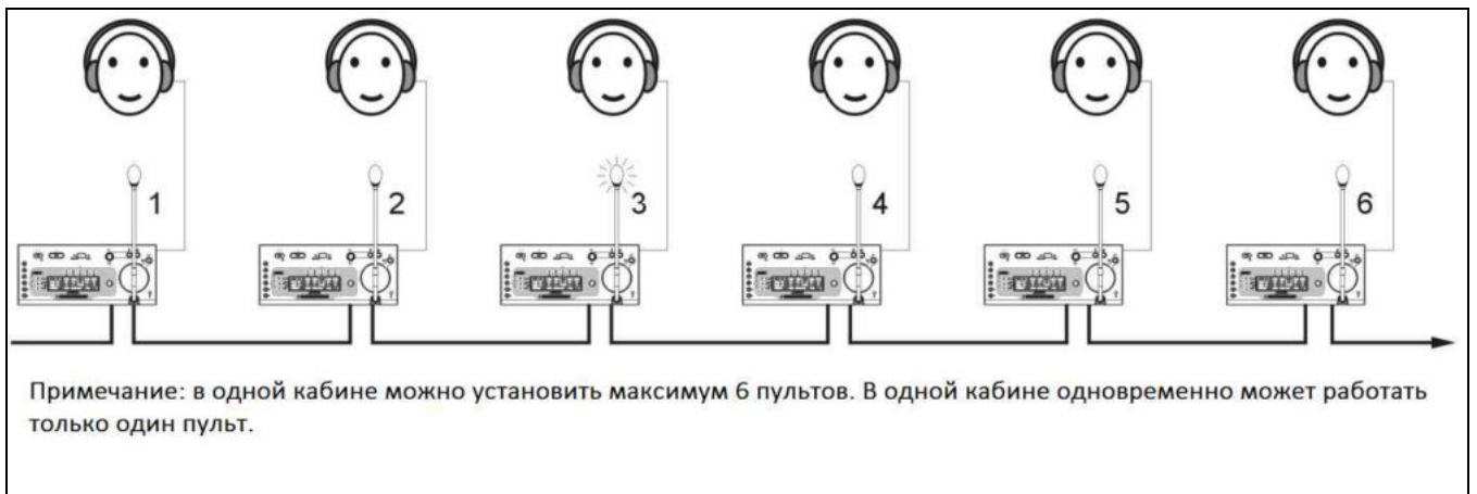
Рис. 4.4.3 Схематическая диаграмма подключения пультов переводчика
